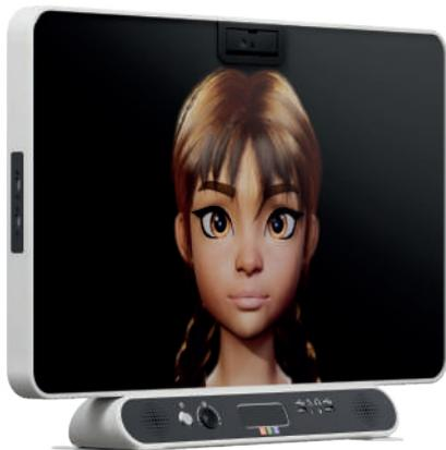
Настольное решение для работы логопедов. В передней части панели кнопка запуска, разъемы подключения USB, наушников и микрофона, регулятор яркости изображения, веб-камера.
