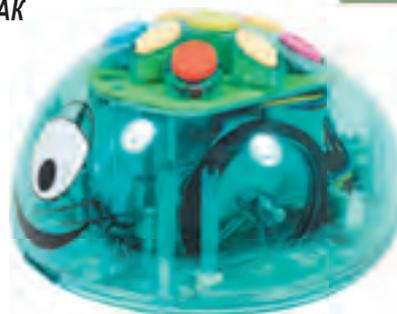
ЛогоРобот КВАК можно подключить к компьютеру для программирования на Scratch и построения более сложных алгоритмов.
