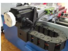
5 Привод поперечного перемещения
