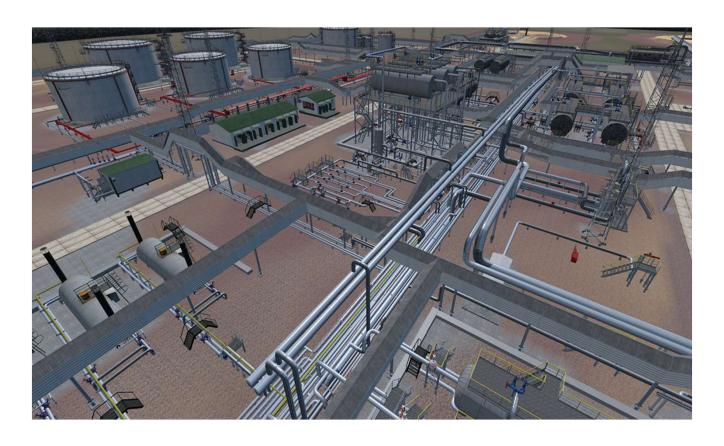
Тренажер УПН – техническое средство профессиональной подготовки специалистов подготовки нефти, создан на основе математического моделирования входящих в него узлов и агрегатов: площадки узла подключения, нефтегазовые сепараторы, отстойники обезвоживания нефти, путевые подогреватели нефти, резервуары нефти, факельные сепараторы, насосные станции, ресиверы, емкости, электродегидраторы.
