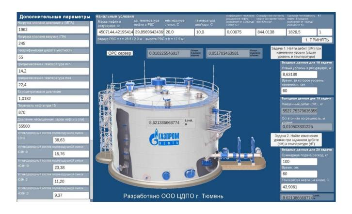
Компьютерный тренажёр: цифровой двойник резервуара вертикального стального (PBC) — это инновационный инструмент, позволяющий оценить объёмы добываемой нефти на основе информации об уровнях, температуре и плотности содержимого в резервуаре. Реальные данные об уровнях вычисляются в режиме реального времени благодаря пересчёту измеренных физических характеристик углеводородной системы (УВС) с использованием плотномеров.
