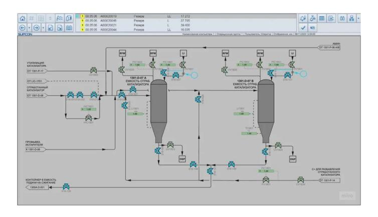
Компьютерный имитационный тренажер для комплектной реакционной установки предназначен для производства линейных альфа-олефинов из этилена, с фокусом на получение бутена-1 и гидрирование фракции C5+.
