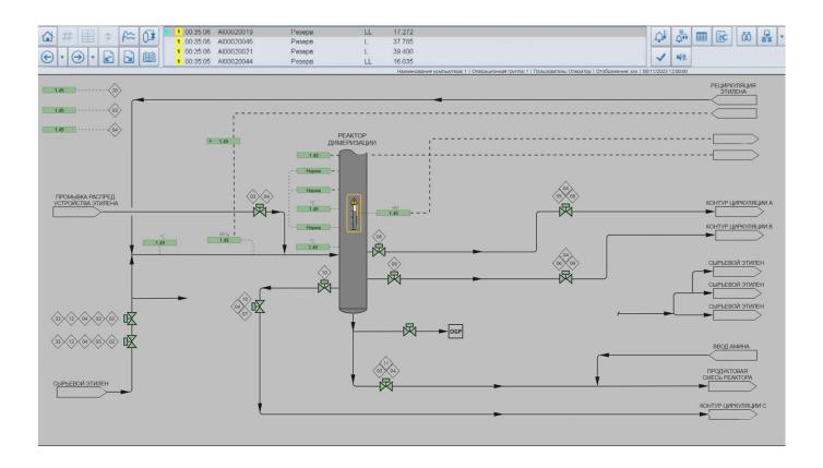
Компьютерный тренажерный комплекс на основе математической модели установки комплектной реакционной установки для (синтеза) линейных получения альфаолефинов из этилена с блоком гидрирования фракции С5+ является инструментом для технологического обучения персонала безопасному управлению процессом, а также подтверждение компетенций и прохождение аттестаций оперативного и технологического персонала.
