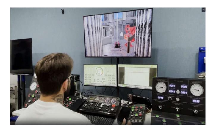
Программно-аппаратный комплекс (ПАК) имитирует процессы бурения и технологи-Позволяя ческого контроля операций. воспроизвести полный цикл жизни скважины разведочного бурения до эксплуатацию, ПАК БУ 5000 становится инструментом для обучения специалистов оптимизации производственных процессов.
