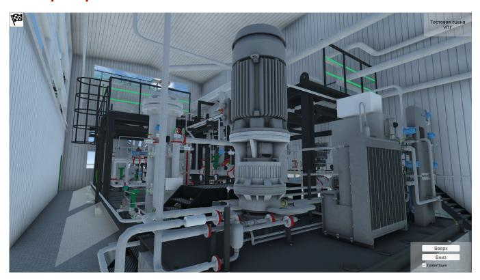
Компримирование газа - Подготовка попутного нефтяного газа (ПНГ) при компримировании «лёгких» неагрессивных и «тяжелых» агрессивных газов является важным процессом в газовой промышленности. Для этого используется специальное наземное оборудование, такое как входной сепаратор, компрессор, маслоотделитель, коалесцентный фильтр, газоохладитель, концевой сепаратор, агрегат системы смазки и факельное хозяйство.
