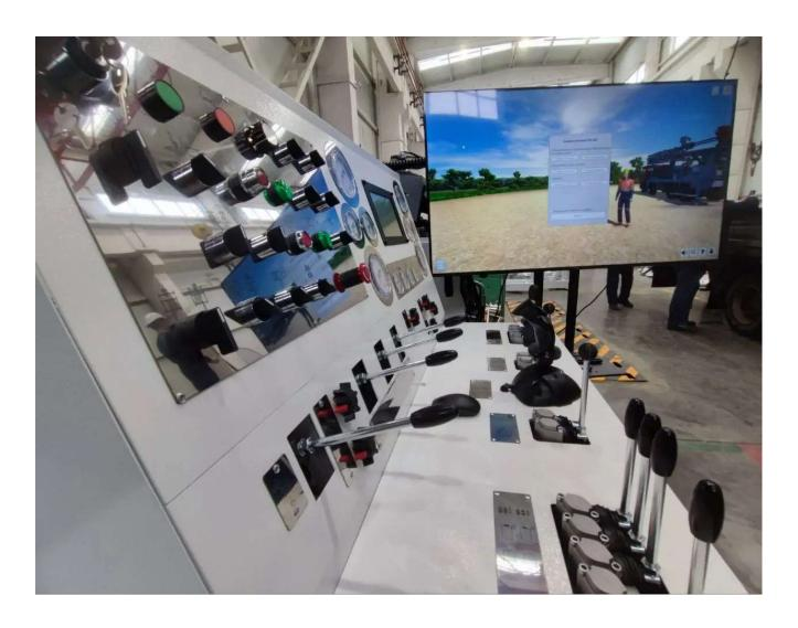
Тренажер буровой установки ZBO для геологоразведочного колонкового бурения, завода бурового оборудования в Оренбурге, представляет собой стенд-имитатор с 3D анимацией для обучения машинистов буровых установок. Он имитирует работу оборудования в виртуальных условиях, позволяя учащимся освоить управление и реагировать на различные ситуации.
