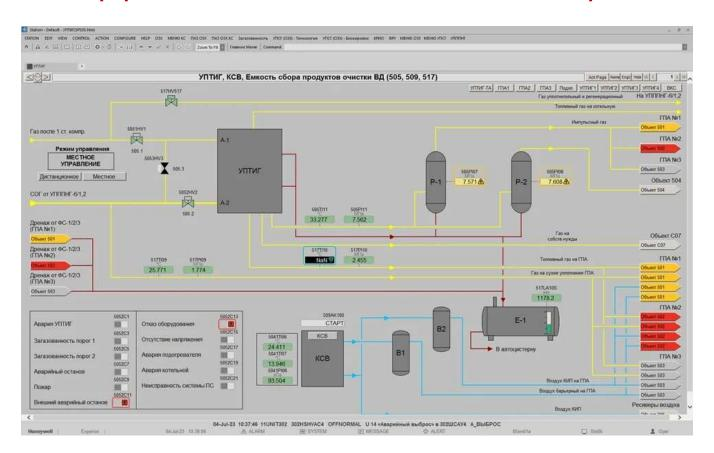
Компьютерный симуляционный тренажер для подготовки сотрудников на участке комплексной подготовки газа УКПГ-2. Тренажер предназначен для приема сырого природного газа от добывающих скважин и его дальнейшей переработки на установках УПППНГ.
