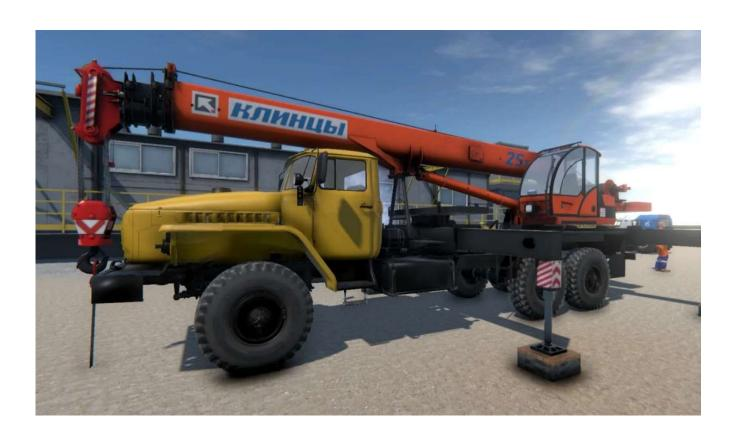
Симулятор Автокран Galacom представляет специализированный программноаппаратный комплекс Кран стреловой автомобильный КС-65731. Он разработан для отработки практических умений и навыков по выполнению крановых операций. Программное обеспечение комплекса включает трехмерные модели оборудования интерактивные схемы управления, аппаратная часть имеет виртуальную копию кабины.
