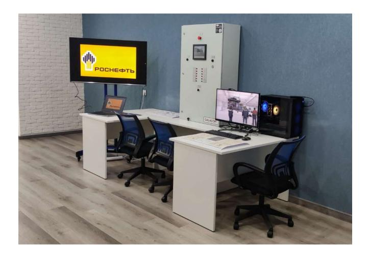
Компьютерный тренажер котел водогрейный собой газомазутный представляет программное обеспечение, которое моделирует работу котла, использующего как энергосырье газ и мазут. Этот тренажер поможет пользователям изучить основные принципы работы и управления котлами, а также провести тренировочные симуляции фактической работы реальным оборудованием.
