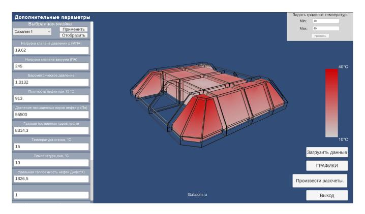
двойник подводных Цифровой танкеров хранения нефти представляет инновационное решение, основанное на системой имитации технологического основе динамической процесса на многопараметрической модели. Математическая модель заполнения подводного резервуара разработана для описания и прогнозирования процессов поступления и накопления жидкости, а также для решения широкого спектра задач, проектированием, связанных С эксплуатацией и мониторингом подводных резервуаров.
